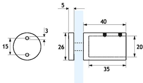
Terminale a vetro con foro per barre fermavetro a sezione rotonda
